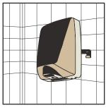
Закрепите защитную защёлку, с помощью винта, чтобы устройство было надёжно прикреплено к стене.
