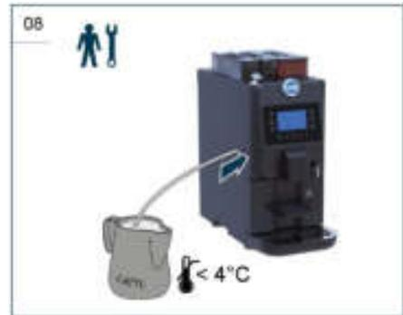
При использовании внешнего устройства подключите к нему выходной патрубков молочного устройства.
