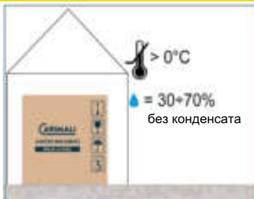
В случае длительного хранения при температурах, не превышающих 2 °C, водяной контур машины должен быть опорожнен покупателем. Не включайте машину, не прогрев ее при комнатной температуре по крайней мере в течение часа. При установке в помещениях, в которых температура воздуха превышает 30 °C, возможно возникновение неполадок.
