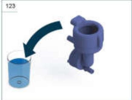
Промойте все компоненты проточной горячей водой.
