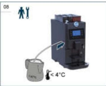
При использовании внешнего устройства подключите к нему выходной патрубок молочного устройства.
