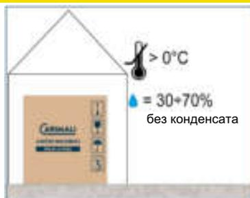
В случае длительного хранения при температурах, не превышающих 2 °С, водяной контур машины должен быть опорожнен покупателем. Не включайте машину, не прогрев ее при комнатной температуре по крайней мере в течение часа. При установке в помещениях, в которых температура воздуха превышает 30 °С, возможно возникновение неполадок.
