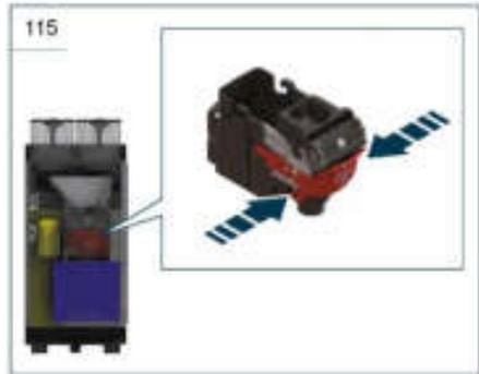
После извлечения CARIBrew из машины очистите ее теплой водой.
