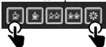
Во время данного цикла мигают все индикаторы, соответствующие нажатым кнопкам, они прекращают мигать при нажатии любой другой кнопки группы (в таком случае загораются все остальные индикаторы, цикл промывания прекращается). Цикл промывания состоит из 5 циклов, каждые по 25 секунд.
