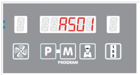
Возможные сообщения о неисправностях выводятся на дисплее печи **DeckTop™** (если она автономная) или на дисплее печи **BAKERTOP MIND. Maps™**, к которому подсоединена печь **DeckTop™** (если она контролируемая).
