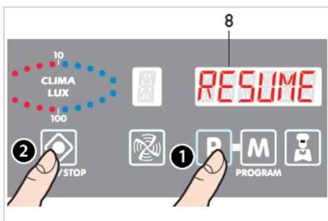
Данная функция в случае преждевременного прерывания программы приготовления (как в ручном, так и в запрограммированном режиме), возобновляет функционирование с точки остановки, сохраняя те же заданные параметры.
