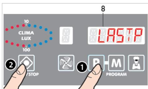
Данная функция позволяет полностью повторить последний выполненный цикл приготовления (только при его выполнении в ручном режиме).
