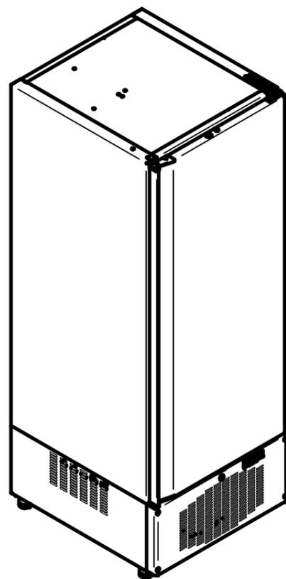
Шкаф холодильный типа ШХ-0,7 (ШХн-0,7;ШХс-0,7) с нижним расположением агрегата предназначен для хранения пищевых продуктов в охлажденном или замороженном состоянии на предприятиях общественного питания и торговли.
