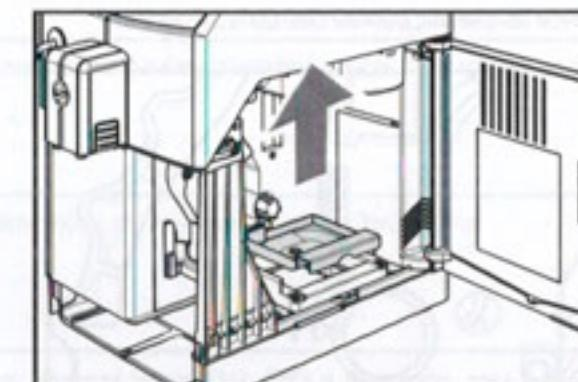
**7** Протрите внутреннее отделение машины влажной тряпкой.
